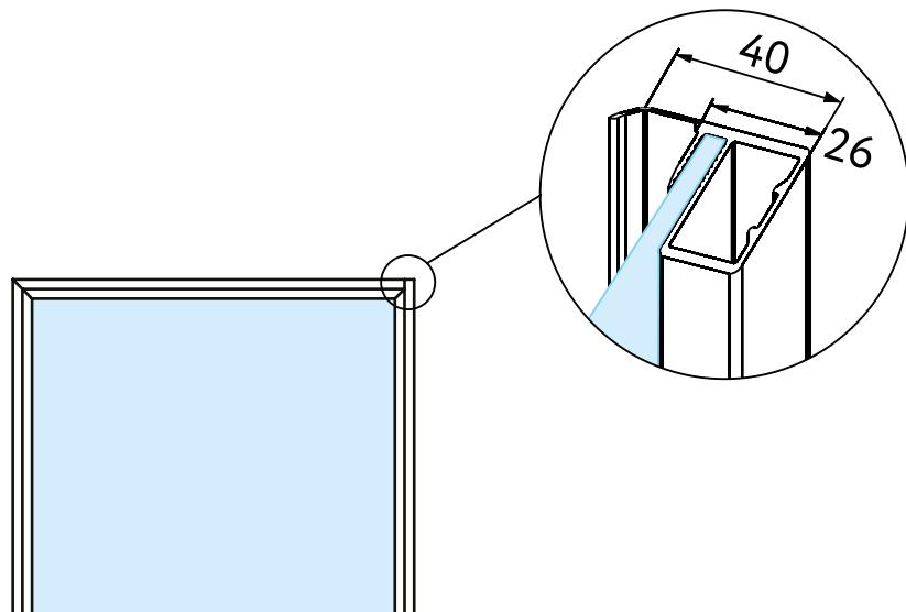
Фасады EDGE (Эдж) – эксклюзивное решение для оформления витринных шкафов. Их уникальность – невидимые петли. Крепления дверей скрыты и незаметны за стеклом – красиво снаружи и внутри. В фасадах используется тонкая алюминиевая рамка с внешней толщиной всего 5 мм. На выбор три цвета профиля и более десятка вариантов вставок: прозрачное, матовое, тонированное и рельефное стекло.
